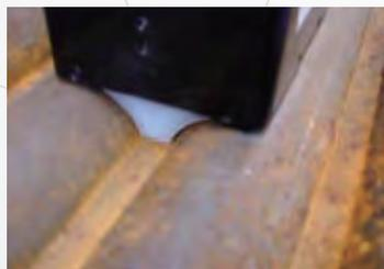
肋片扫描器用于检测管道与肋片的接口处以及两个管道的接口处。加强型肋片扫描器还可以检测接口处附近的腐蚀应力裂纹
