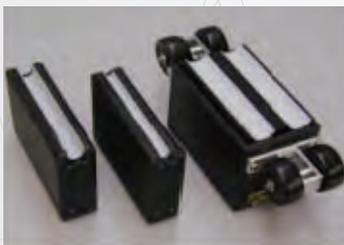
小管径扫查器，可用于检测钢管直径小于1" (25mm)的扫查器
