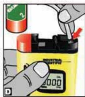
在校零完成后，气体报警器将蜂鸣，意味着它已经进入标定程序。此时仪器将会提示通入标准气的浓度
