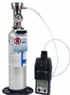
泵吸式监测仪和被动式恒流阀。
