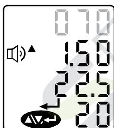
重复该步骤直至完成所有四个高浓度报警设定点的设置。当设置全部完成后，屏幕上会一直出现“ $\text{🔊}$ ”，“ $\blacktriangle$ ”，“ $\leftarrow$ ”和“ $\text{↔}$ ”图标，以及四种气体的高浓度报警设定点。此时，若按 $\downarrow$ 键将返回该模式，您可以重新设置高浓度报警设定值；若按 $\uparrow$ 键，您就可以继续进入到TWA报警设定值设置页面。在数值闪动时若按一下 $\text{⏻}$ 键，即可返回最初的高浓度报警设置页面，但所设置变更将不被保存。再按一次 $\text{⏻}$ 键，仪器返回常规气体读数模式页面。高浓度报警器是非锁定报警器。
