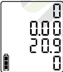
一旦仪器进入气体读数模式后，就开始对全部四种气体（ $O_2$ ， $CH_4$ ， $CO$ ， $H_2S$ ）或其中的几种进行连续不间断的检测，并且实时更新液晶显示屏上的检测数据。在屏幕的左下角还有一个电池电量指示标志，用以提醒用户电池的电量状况。当电池电量减少时，图标的阴影部分也会随之减少。如果上述任何一种气体的浓度超过了低浓度或高浓度报警设定值（包括STEL/TWA报警设定值），仪器就会发出报警。在报警状态下，仪器按一定频率发出低频蜂鸣（低浓度报警），高频蜂鸣（高浓度报警），光报警以及振动报警。当气体浓度低于报警设定值时，仪器将返回到气体读数模式。在气体读数模式下，还可以通过按 $\text{⬆}$ 键进入另外4个模式。
