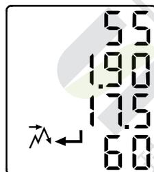
在气体读数模式下，按2次
