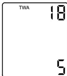
在气体读数模式下，按
