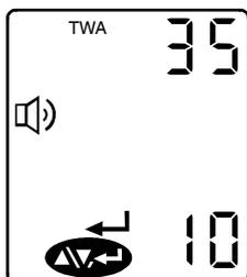
这是第三个设置屏幕页面。屏幕显示“TWA”，“ $\text{🔊}$ ”，“ $\leftarrow$ ”和“ $\text{↔}$ ”图标，以及两种气体的TWA报警设定点。如果不需要任何改变，按 $\uparrow$ 键前进至下一屏。如果需要改变数值，按 $\downarrow$ 键。此时，屏幕上第一个TWA报警设定值将闪动。按 $\uparrow$ 和 $\downarrow$ 键调整数值。设置完毕后按 $\downarrow$ 键选择设置下一个TWA报警值。重复该步骤直至完成两个TWA报警设定点的设置。当2个TWA设置全部完成后，屏幕上会一直出现“TWA”，
