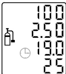
仪器具有快速标定功能，只要使用一个含有混合气体的气瓶就可同时给所有传感器标定。使用快速标定功能，可一次性完成仪器的标定。您既可以单独给仪器标定，也可以将其连接在采样泵上进行标定。如果仪器连接SP40采样泵进行标定，请用一根标定软管，一头接在采样泵的一端，另一头与混合气体气瓶上的被动式流量阀相连(当用一个压力流量阀，并带SP40采样泵标定时，需将SP40标定软管组件与压力流量阀与SP40采样泵相连)。如果不带SP40采样泵而单独给仪器标定，请将M40标定杯稳固地套在传感器上，用标定气管连接标定杯与混合气瓶上的流量阀。
