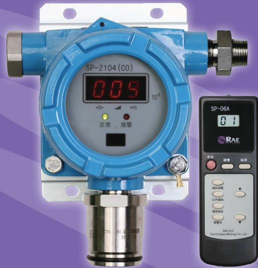
SP-2104 是一款隔爆型、固定安装方式的有毒气体检测仪。检测仪采用电化学传感器技术，具有现场 LED 显示，红外遥控调节及设定参数等功能，可检测 CO、H<sub>2</sub>S 等有毒有害气体。
