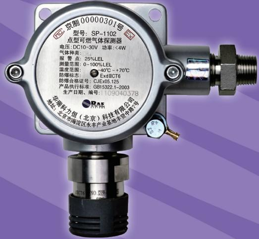
SP-1102 是一款隔爆型、固定安装方式的可燃气体检测器，具有性能稳定、功耗低、电源范围宽、灵敏可靠、使用寿命长、无源开关量输出等特点。该仪器可以长期连续工作。因而被广泛应用于石油化工、化学工业、油田、油库、液化汽站、污水站、环保、消防等领域及其它存在可燃性气体泄漏的场所。在一些需要长期连续检测的危险场所，该探测器更能发挥其卓越的测爆、防爆作用。
