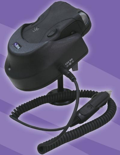
GammaRAE II R R 是用于对未知放射性环境进行  $\alpha$ 、 $\gamma$  射线快速检测的高灵敏度辐射测量仪表。是环境监测、国土安全、边防口岸、商检、海关、机场、消防、应急救援、防化部队等部门用于日常巡测和搜寻微弱放射源工作的首选报警仪表。不仅能对辐射环境剂量率及剂量进行全天候监测计量报警，还具有强大的无线传输及后台软件管理功能。为了使用的方便，本仪器设计了一个车载充电器，可以在仪表使用途中利用车载点烟器进行充电。
